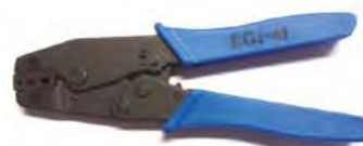
Pinza art. 41 per tubetti nudi e preisolati da 6-16 \text{mm}^2
